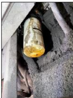
Fuite sur support de filtre à huile
